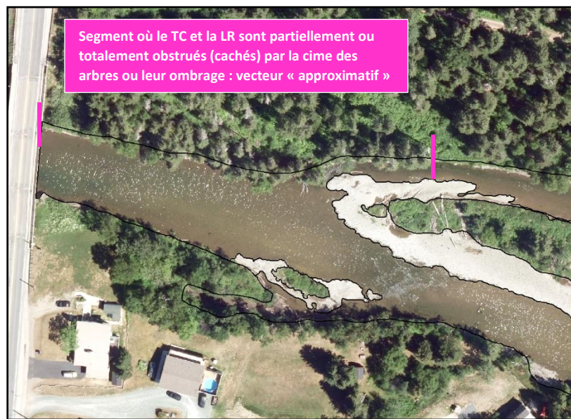
FIGURE 4. EXEMPLE DE POSITIONNEMENT « APPROXIMATIF » DU TRAIT DE CÔTE ET LA LIGNE DE RIVAGE.
