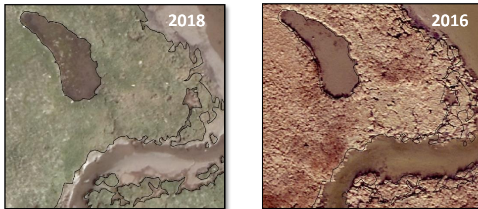
FIGURE 11. LÉGER DÉCALAGE DE L'ORTHOPHOTOGRAPHIE NUMÉRIQUE DE 2016 FACE À 2018.
